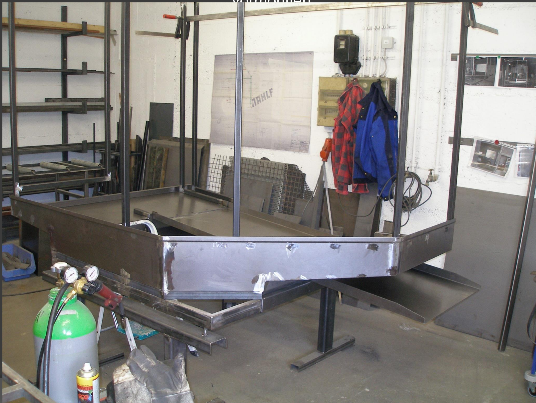
Das Grundgestell wird mit Schiebetüre und Revisionstüre kompl. vormontiert
