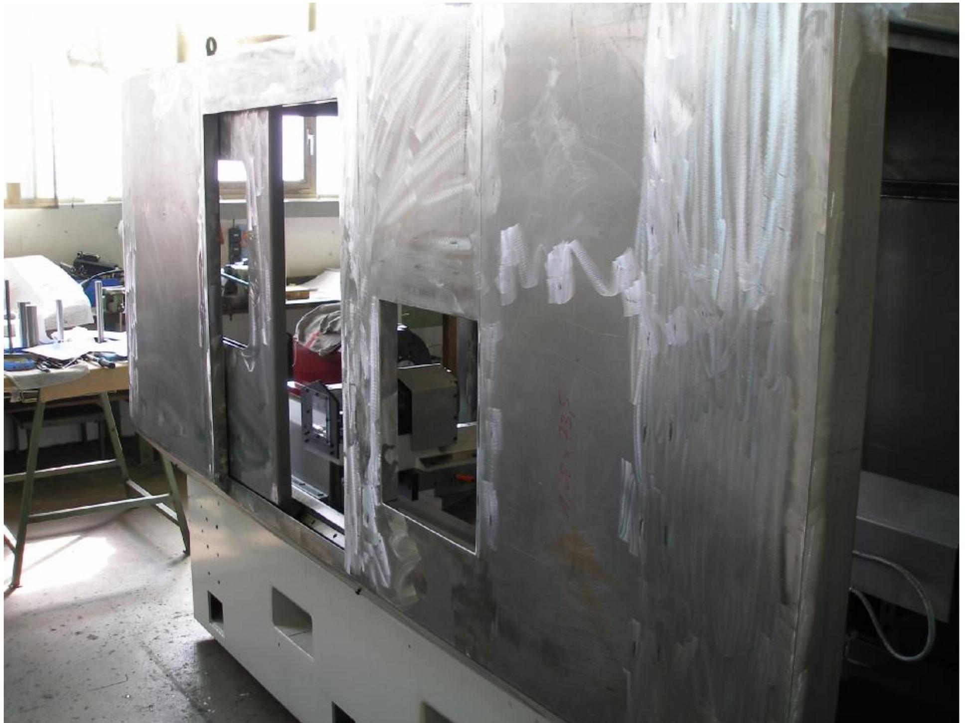
**Schutz-Umhausung fertig lackiert und montiert.**
