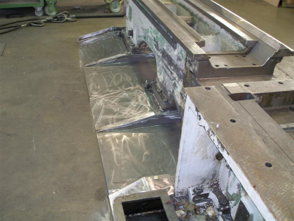
Maschine erhält eine neue Rückwand für Späneförderer und Schaltschrank. Zudem wurde eine neue Schutztüre verfahrbar über ganze Maschinenlänge
