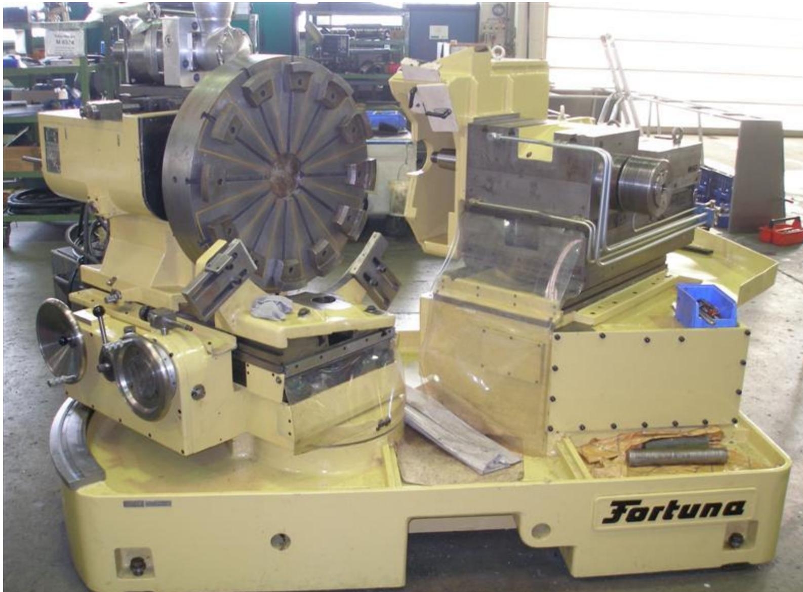
Zu Beginn wurde ein Grundrahmen gefertigt der genau ans Maschinenbett angepasst wurde.
