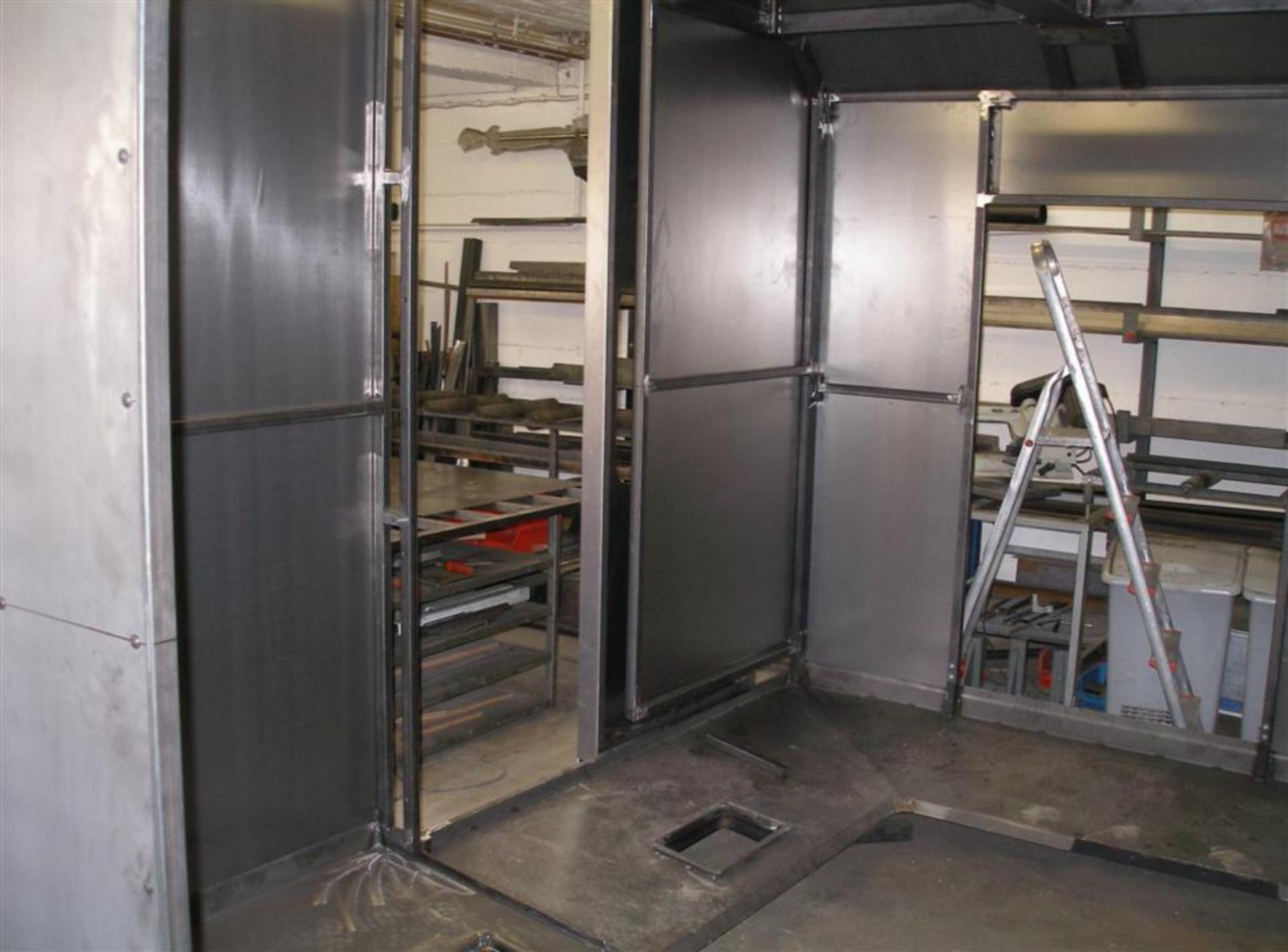
Jetzt wurde die Umhausung auf der Maschine montiert um letzte Arbeiten wie Halterungen für Elektrik und Hydraulik zu montieren bevor es in die Lackierei geht.
